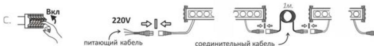
Рисунок 2 - Схема монтажа двух и более линейных прожекторов Geniled с использованием соединительного кабеля.
